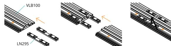
**3** Assemblez les traverses de renfort à l'aide des connecteurs à bouton poussoir.
