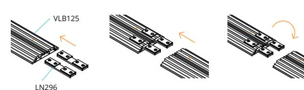
**3** Assemblez les traverses de renfort à l'aide des connecteurs à bouton poussoir.
