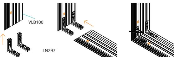
**2** Assemblez les sections droites à l'aide des connecteurs et des repères de montage.
