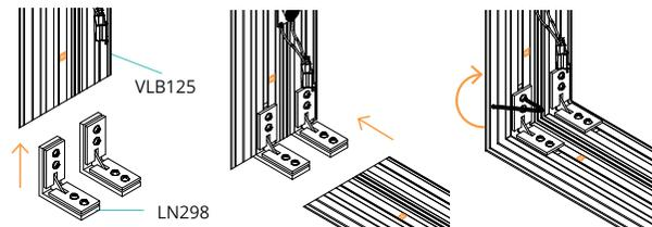
**2** Assemblez les sections droites à l'aide des connecteurs et des repères de montage.
