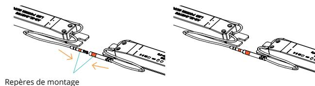
**8** Reliez le cordon d'alimentation au courant électrique en utilisant le passe-câble du cadre.
