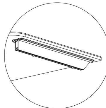
1/ Poser la tablette sur le comptoir monté et ajuster pour que les perçages soient en face de l'insert fileté **FX866** (déjà intégré dans la tablette)
